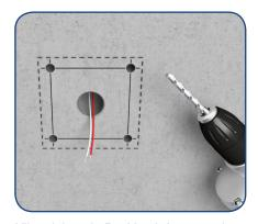
Klingelplatte in Position bringen und Lochabstände auf der Wand markieren. Anschließend nach mitgeliefertem Montageplan bohren.
