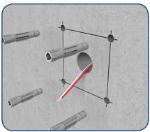
Dübel bündig in die Wand stecken.
